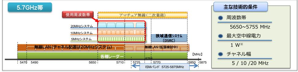
※既存の無線LANシステムと比較すると約4倍(EIRP比較では約10倍)の増力
